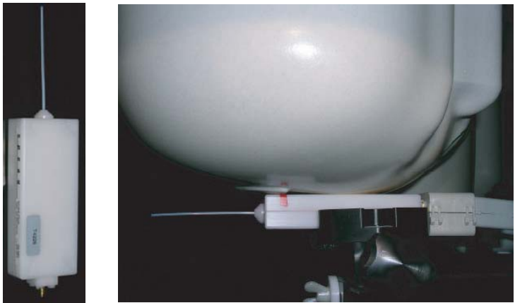
Abbildung 82: Generisches Mobiltelefon mit Monopolantenne für 900 MHz (links), SAR-Messung am SAM-Phantom (rechts)
