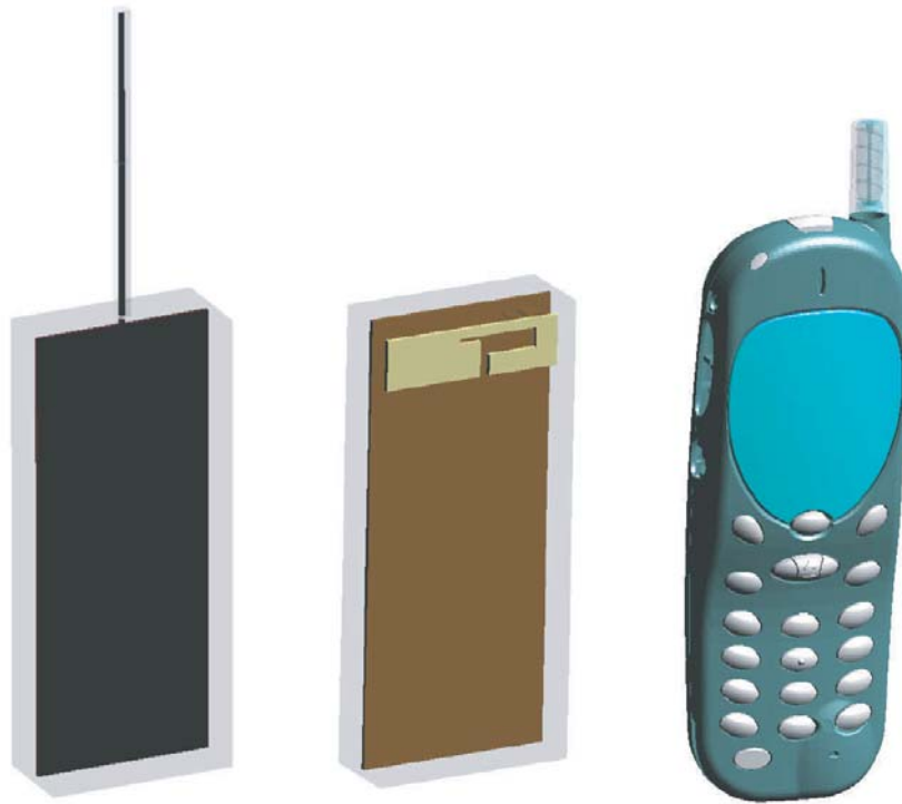
Abbildung 14: Telefonmodelle von links nach rechts: generisches Telefon mit Monopolantenne für 900 MHz [50], generisches Telefon mit integrierter Zweibandantenne [51], Motorola Timeport T250 [52]
