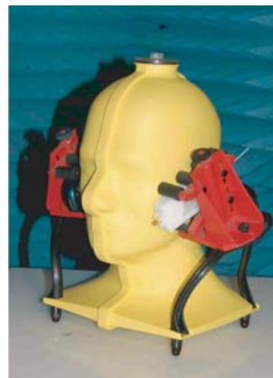
Abbildung 84: links: Temperaturanstieg an der Wange und am Ohrreferenzpunkt des SAM-Phantoms bei periodischer Befeldung durch das generische Telefon mit 10 W/kg, rechts: Testanordnung zur Temperaturerfassung: mit gewebesimulierendem Gel gefülltes SAM-Phantom und generisches Telefon
