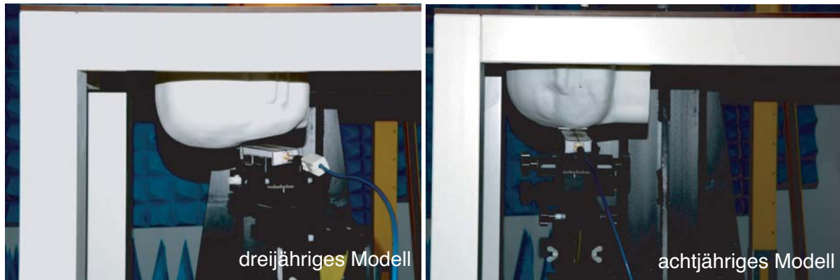
Abbildung 90: Messung der SAR in den beiden Kinderkopfmodellen
