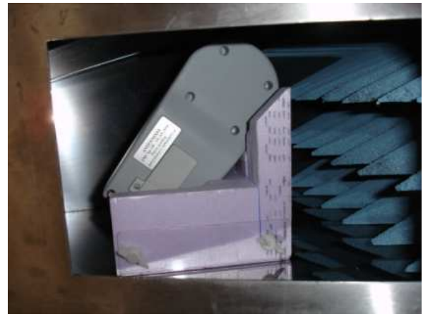
Abbildung 5.3: Lage 1 (links) und 2 (rechts) des Dosimeters mit Halterung in der Zelle
