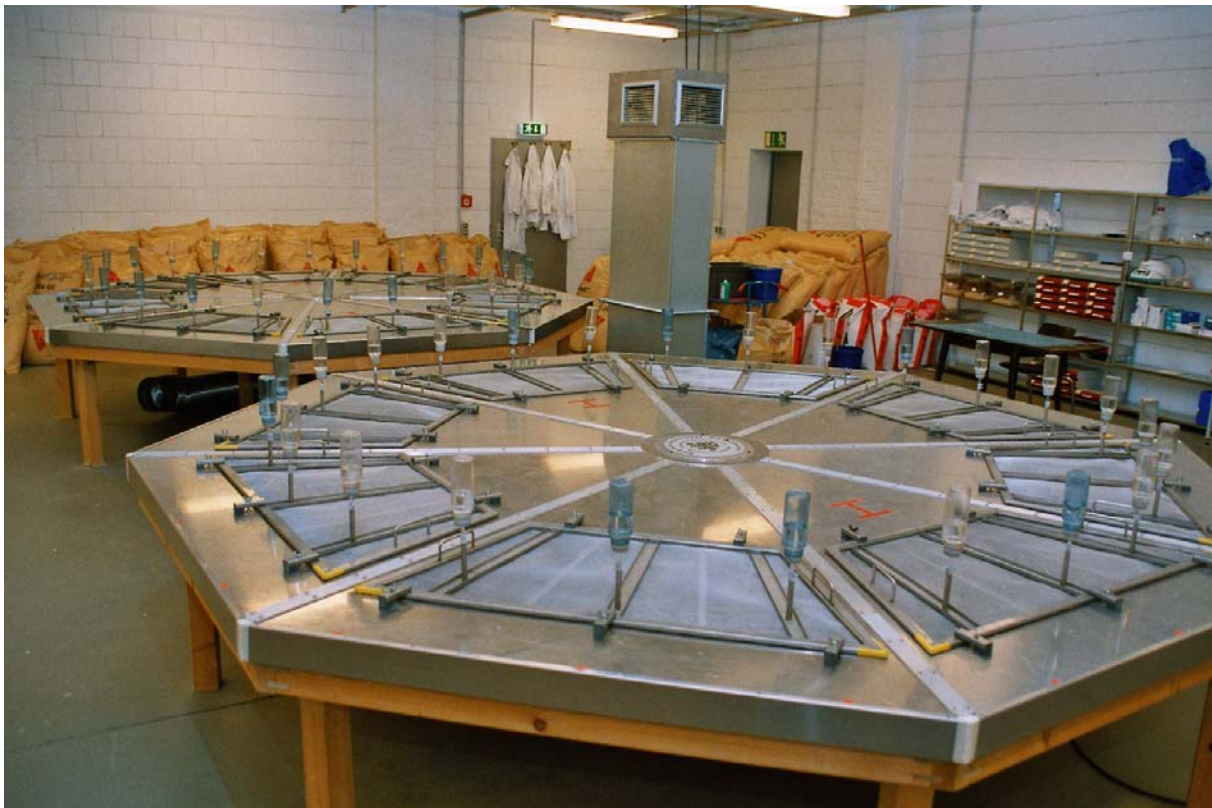
Abb. 1: Zwei identische Expositionsanlagen für die exponierten und schein-exponierten Tiere ermöglichten den Versuch verblindet durchzuführen.
