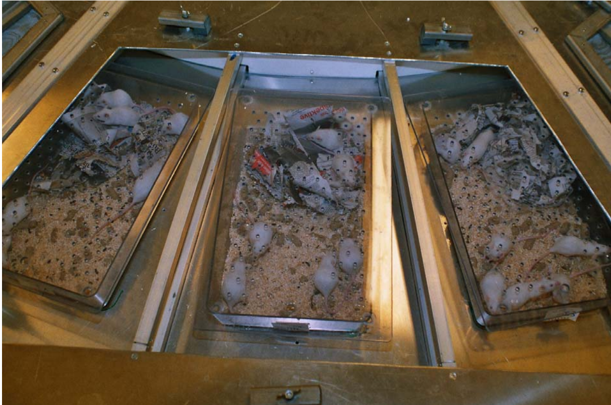
Abb. 4: Trapezförmige Öffnungen innerhalb der oberen Platte des strahlenförmigen Wellenleiters ermöglichten das Hantieren mit den Käfigen (3 Käfige pro Öffnung), sowie den Austausch von Luft und das Eindringen von Licht in die Käfige. Die Käfige waren mit Plexiglasscheiben abgedeckt, die mit vielen Bohrungen versehen waren.
