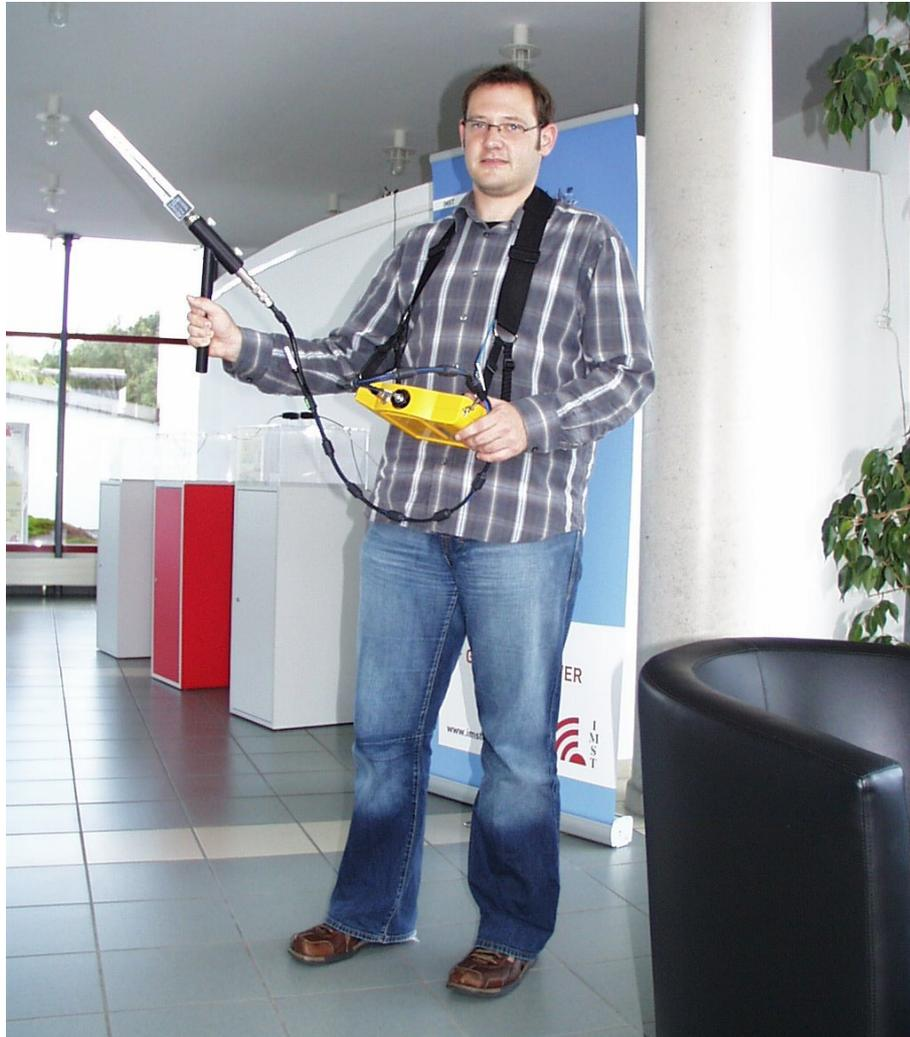
*Bild 4.1: Messverfahren mit Spektrumanalysator (gelb) und Empfangsantenne*
