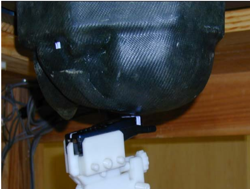
Messaufbau für die Messung des Nahfeldes mit Kopfphantom
