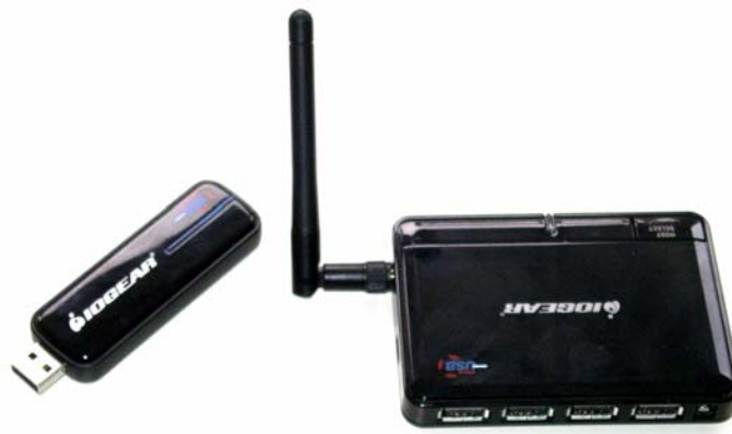
Abbildung 8.2: Adapter (links) und Hub (rechts) des IOGEAR Wireless USB Produkts GUWH104KIT
