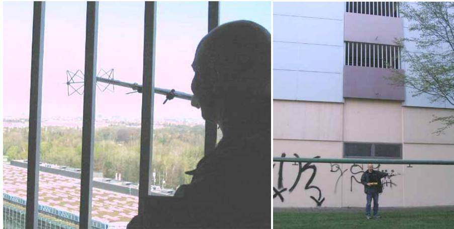
Bild III.2.23: Messung im Treppenhaus außerhalb der Vergitterung und unterhalb des Treppenhauses vor *Gebäude 1*
