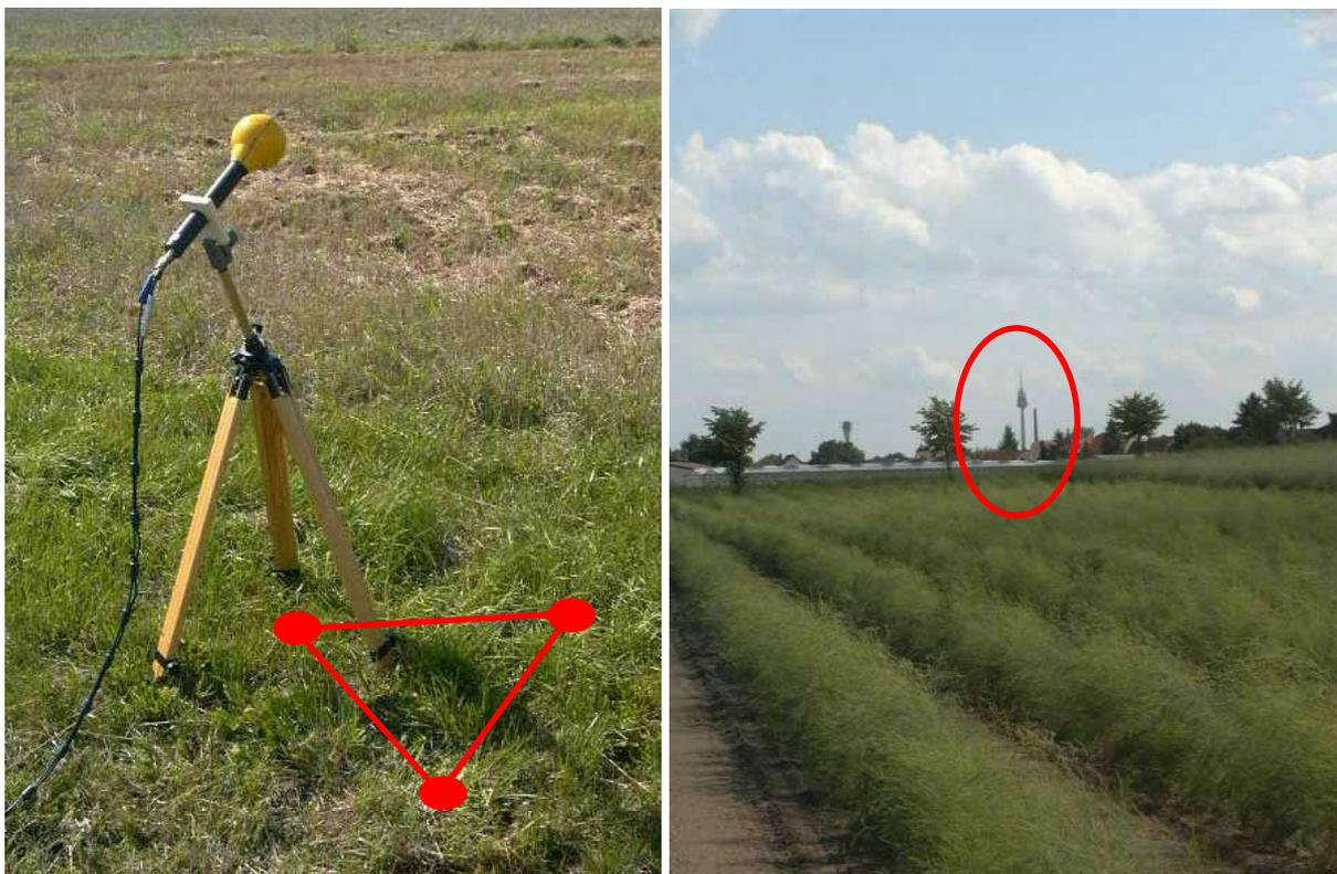
Bild II.4.1: Messaufbau "Einzelpunktmessung" mit isotroper Antenne (links) und Fernmeldeturm Nürnberg (rechts)
