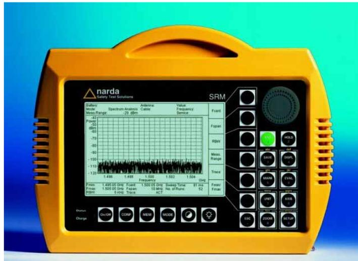
Bild II.4.12: Verwendeter Analysator: Narda SRM-3000
