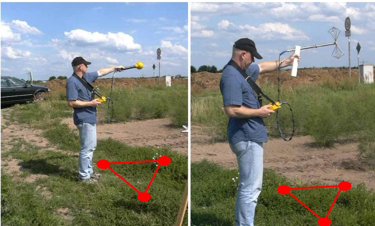
Bild II.4.2: Messaufbau "Schwenkmethode" mit isotroper Antenne (links) bzw. bikonischer Antenne (rechts)
