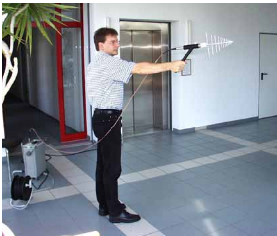
Bild I.4.1 Frequenzselektives Messverfahren mit Spektrumanalysator und Messantenne
