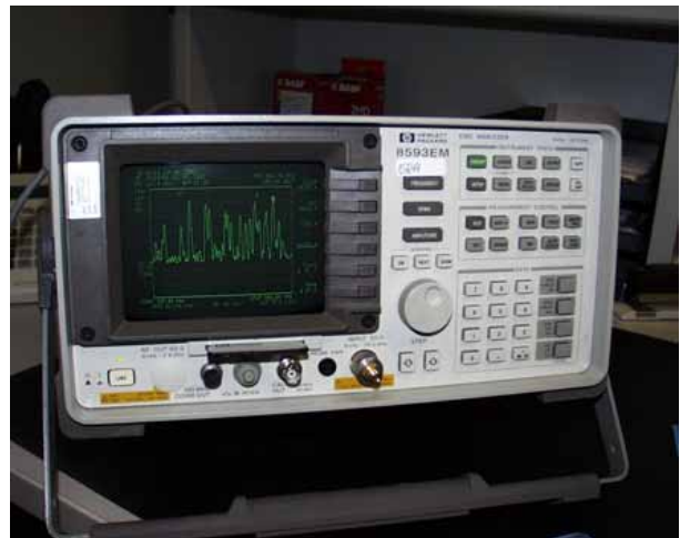
Bild I.4.1 Frequenzselektives Messverfahren mit Spektrumanalysator und Messantenne
