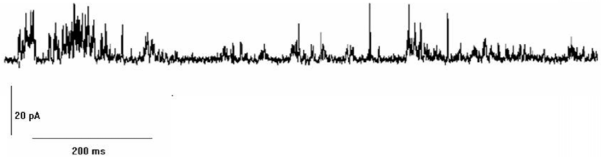
Abb. 4.2: Stromspuren (I-t) von D15PC/DOPC bei T = 38^\circ \text{C} in der fluiden Phase. Es treten Stromspitzen im Bereich von ca. 10 - 20 pA auf. Die Klemmenspannung beträgt U = 90 \text{ mV} .
