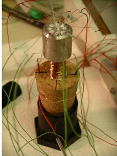
Abbildung 6.14: Vorrichtung zur thermischen Kalibrierung mit Heizvorrichtung; Thermistoren in radialer Anordnung in Bohrung mit Wärmeleitpaste thermisch kontaktiert
