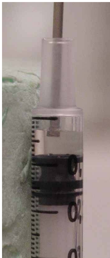
Abbildung 6.5: Beispiel einer Peri/Endolymphe-Messung (Messkopf-Durchmesser ca. 1 mm)
