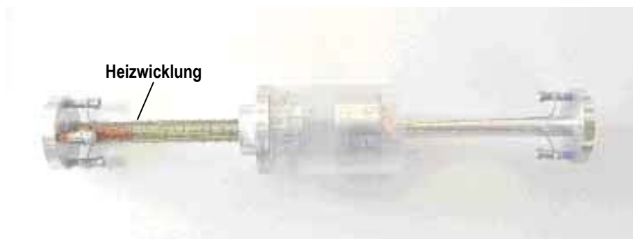
Abbildung 6.7: Kalorimeter zur Bestimmung der thermischen Parameter von biologischem Gewebe
