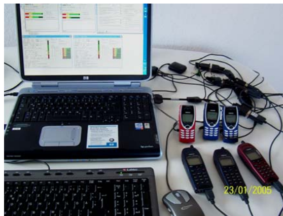
Abbildung 8: Konfiguration der Messeinrichtung für den Vortest bestehend aus drei Nokia 8210 und drei Nokia 6150 GSM Dualband-Handys mit Schnittstellenvervielfachungskarte und Monitorsoftware
