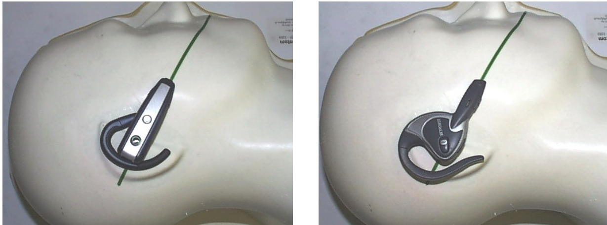
Abbildung 2.19: Mögliche Positionierung von Bluetooth Headsets am genormten SAM-Kopfphantom zur SAR-Messung
