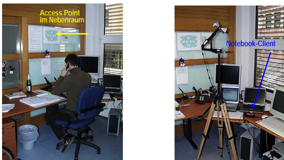
Abbildung 5.10: Untersucher Büro-Arbeitsplatz. links: typische Nutzung; rechts: Aufstellung der Messantenne
