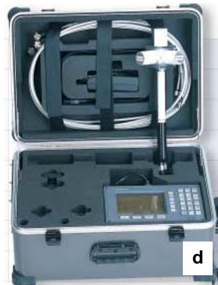
Abbildung 3.20: Auswahl von verschiedenen, gegenwärtig am Markt erhältlichen, Mess-Systemen zur frequenzselektiven ‚quasi-isotropen‘ Erfassung von Immissionen im Frequenzbereich der modernen Drahtlostechnologien.
