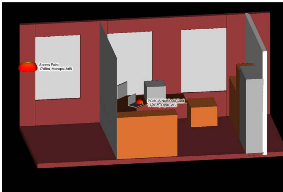
Abbildung 5.14: Vereinfachte Modellgeometrie in Wireless Insite (Version 2.0.5) für das untersuchte WLAN-Szenario (Büro-Arbeitsplatz, vgl. mit Abbildungen 5.7 bis 5.9)
