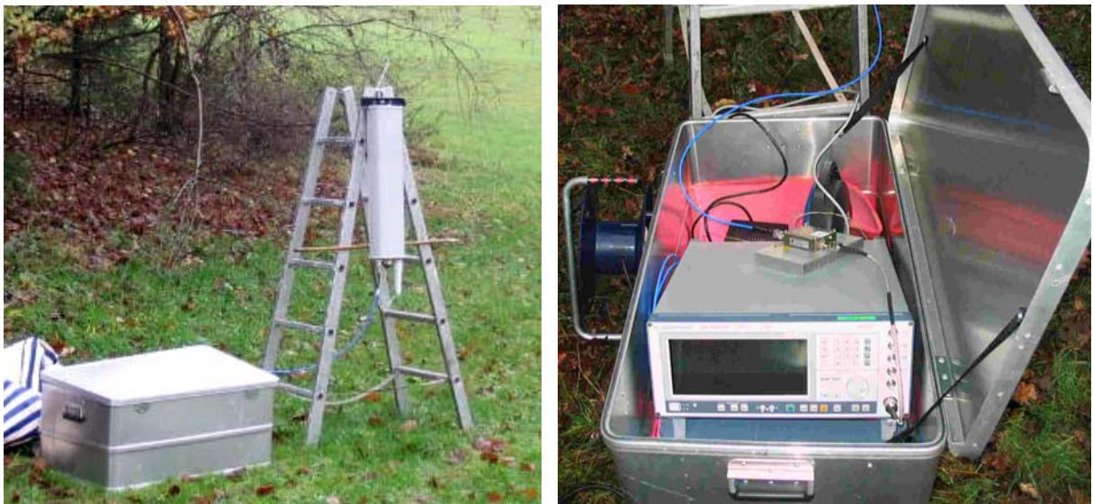
Bild II.4.3: Simulierter „Mobilfunkstandort“: Aufbau (links) bzw. Signalgenerator mit Endstufe (rechts)
