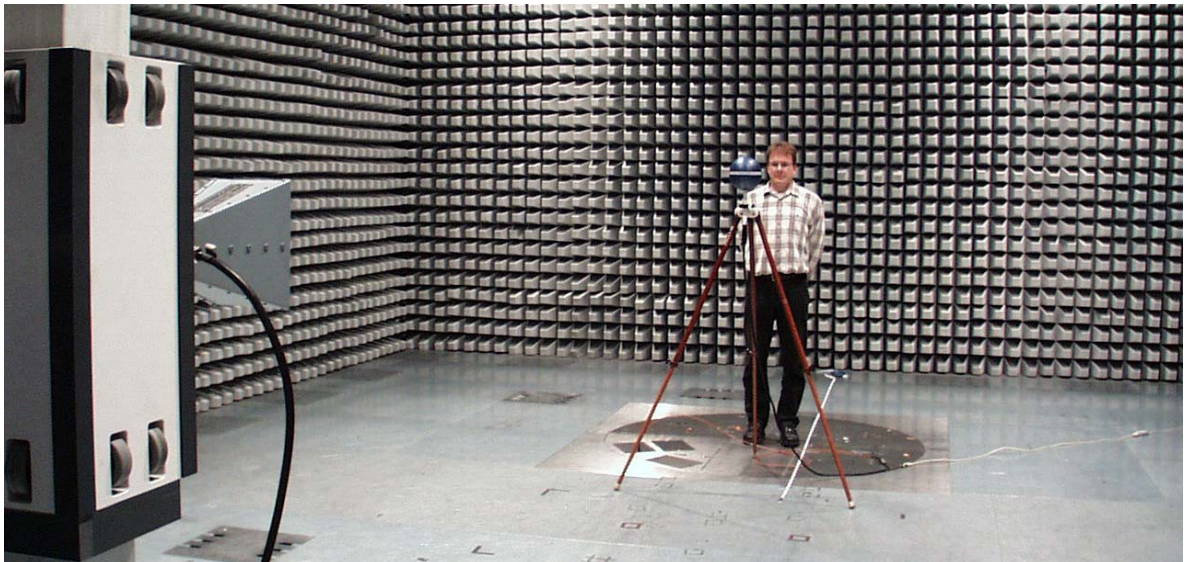
Bild II.4.24: Messaufbau zur Untersuchung des Einflusses des Messenden auf die Messergebnisse bei verschiedenen Antennentypen
