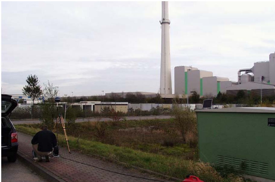
Bild II.4.34: Messort für das Szenario outdoor mit Sicht zum UMTS-Sender; Entfernung zur Basisstation 363 m. Die Antennen befinden sich auf der Umkränzung am Turm.
