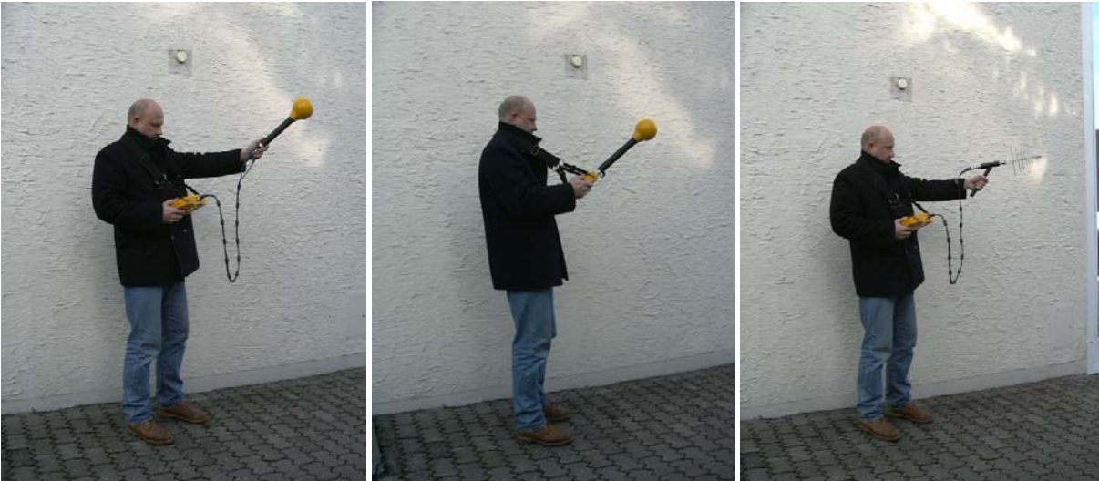
Bild II.4.22: Drei verschiedene Möglichkeiten zur Abtastung des Messvolumens: Handgeführte Isotropantenne (links), Isotropantenne mit dem Messgerät verbunden (Mitte) und Messung mit handgeführter einachsiger Antenne (rechts)
