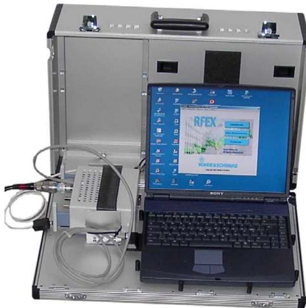
Bild II.4.18: Portables, codeselektives UMTS-Messsystem (mit TSMU und Steuerrechner), Firma Rohde & Schwarz
