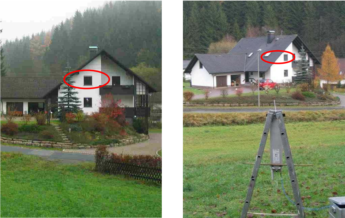
Bild II.4.4: Blick vom Antennenstandort zum Messort; Links: LOS-Szenario, rechts: NLOS-Szenario
