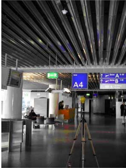
**Abbildung 5-42:** Aufstellung der Mess-Sonde nahe dem Access Point auf Kanal 11.
