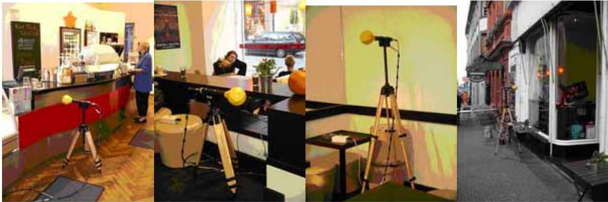
Abbildung 5-24: Aufstellung der Mess-Sonde in Messpositionen MP1, MP3, MP4, MP5 (von links nach rechts).
