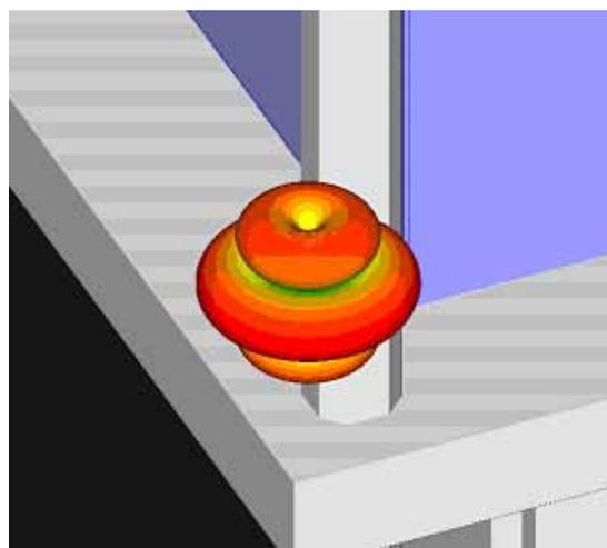
**Abbildung 6-6:** Modelliertes 3D Pattern der Antenne.
