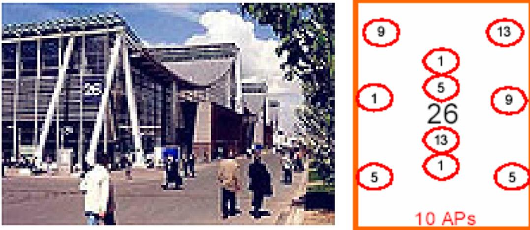
Abbildung 7-1: Halle 26 von außen (links) und Hallengrundriss mit Access Point und genutzten Kanälen (rechts).
