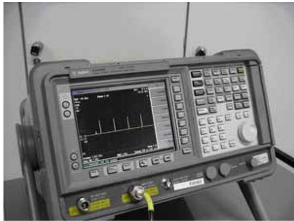
**Abbildung 3-7:** Mess-System SRM 3000 von NARDA (links) und Spektrumanalysator E4405B von Agilent (rechts)
