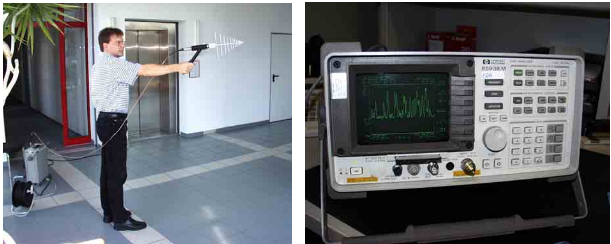
Bild 2.5.1 Durchführung einer frequenzselektiven Messung mit Spektrumanalysator und Empfangsantenne (links) und Detaildarstellung eines Ergebnisses auf dem Spektrumanalysator (rechts)
