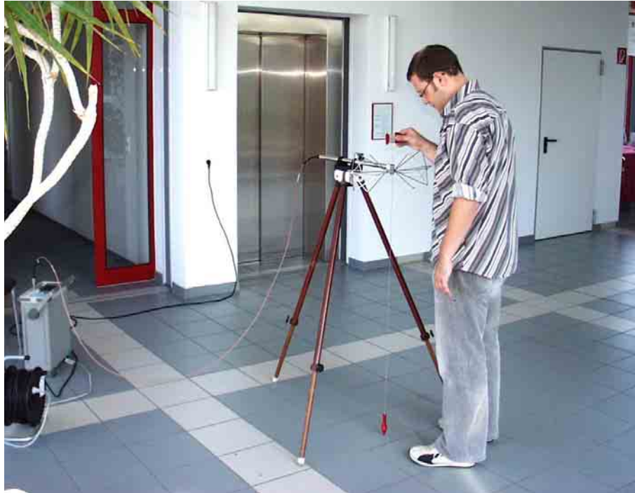
Bild 2.5.13 Durchführung der Punktrastermethode; Ausrichtung der Antenne auf einen Rasterpunkt
