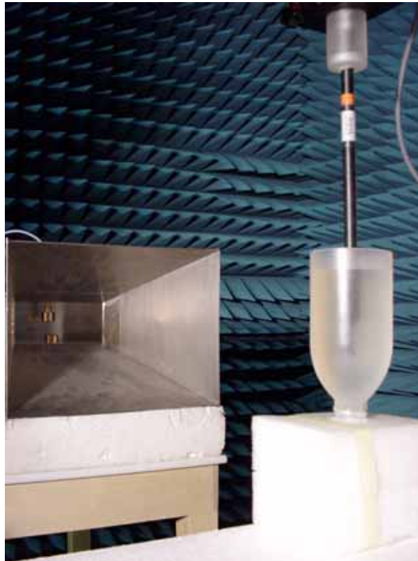
Abbildung 106: Messanordnung mit Hornantenne und gefülltem Rattenphantom
