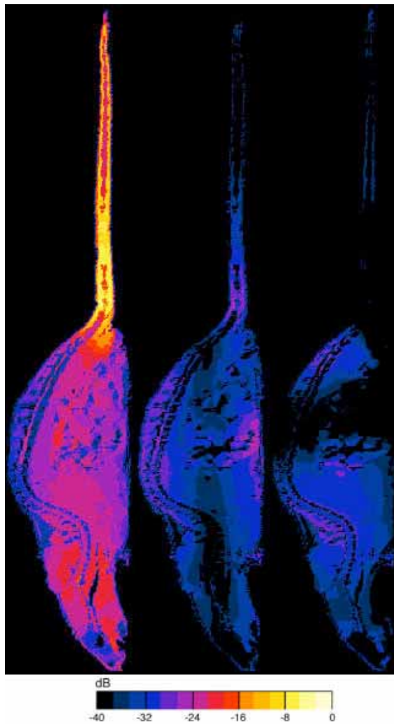
Abbildung 58: SAR-Verteilung in einem Längsschnitt durch die Ratte unter E-, H- und k-Polarisation (von links nach rechts) bei 450 MHz ( 0 \text{ dB} = 5.5 \text{ (W/kg)/(W/m}^2) )
