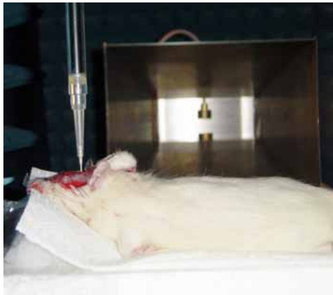
Abbildung 111: Messaufbau mit Hornantenne, Rattenkadaver und Messsonde für H- Polarisation
