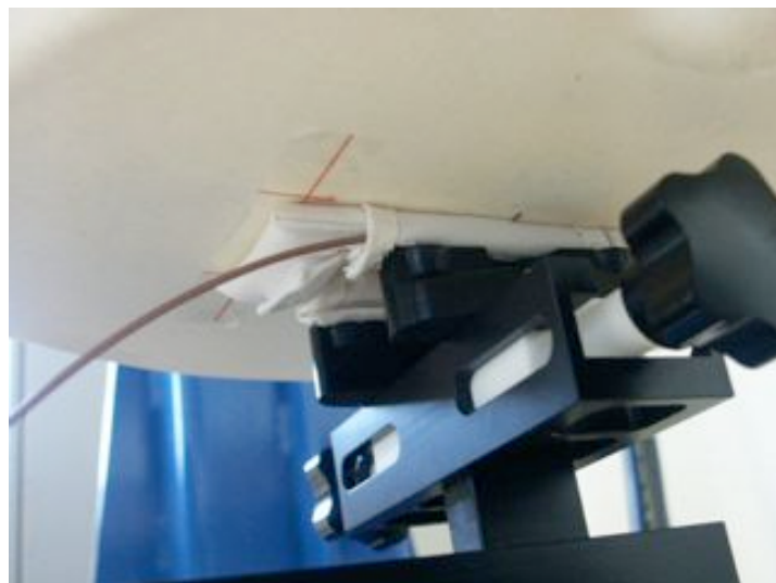
Abb. 13: Positionierung der Dualband-Antenne mit Stoffhülle im Flachbereich des SAM-Phantoms.
