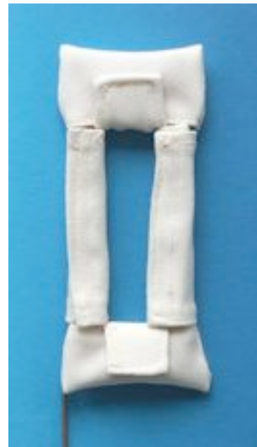
Abb. 11: Rückseite der Dualband-Antenne mit Stoffhülle.
