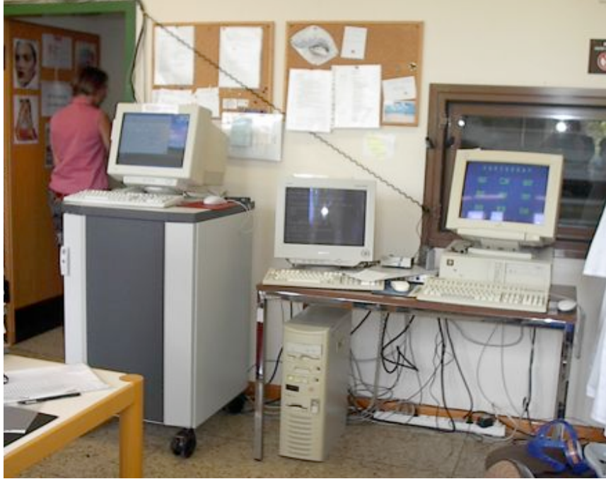
Abb. 5: Messplatz: links: Expositionseinrichtung mit Steuerrechner, rechts: Steuerrechner für das polygraphische Aufzeichnungsgerät, Mitte: Steuerrechner für Tagesexperimente
