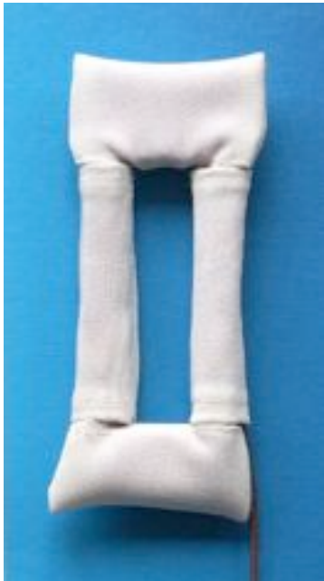
Abb. 10: Vorderseite der Dualband-Antenne mit Stoffhülle.
