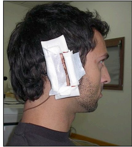
Abb. 34: Proband mit Dualband-Antenne mit Stoffhülle
