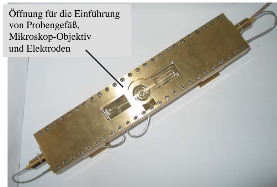
Bild 18: Aufsicht der GSM1800-Expositionseinrichtung
