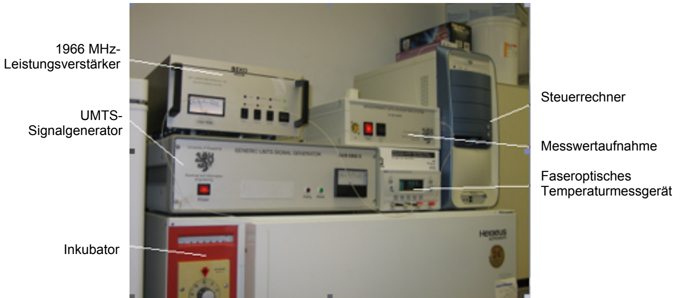
Abb.12: Elektronische Komponenten der UMTS-Expositionsanlage
