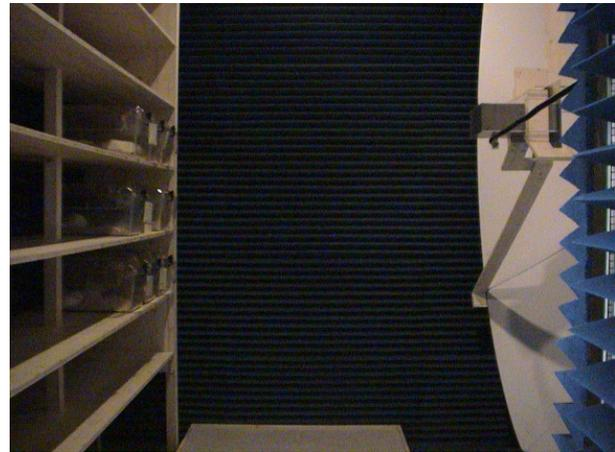
**Abb. 2.13:** Blick in eine Befeldungskammer, links: Regal mit Tierkäfigen, rechts: Reflektor mit Primärstrahler.
