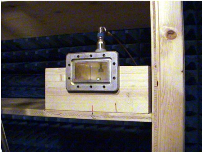
**Abb. 2.14:** Messantenne im UMTS Aufbau bei Messung ohne Tiere.
