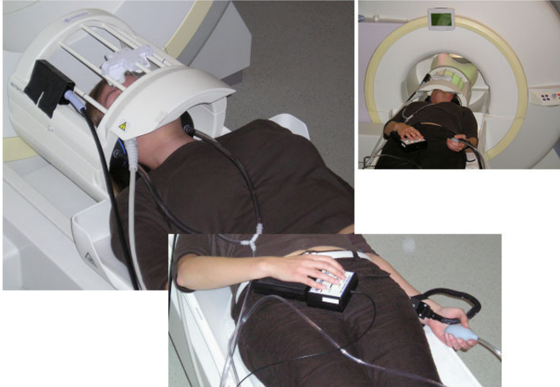
Abbildung 5: Untersuchungsaufbau im fMRI-Paradigma (oben links: Lokalisation des Dummy-Handies an der Magnetspule; oben rechts: Gesamt-Setting; unten: Notball, Lumitouch und Wärmeapplikation)
