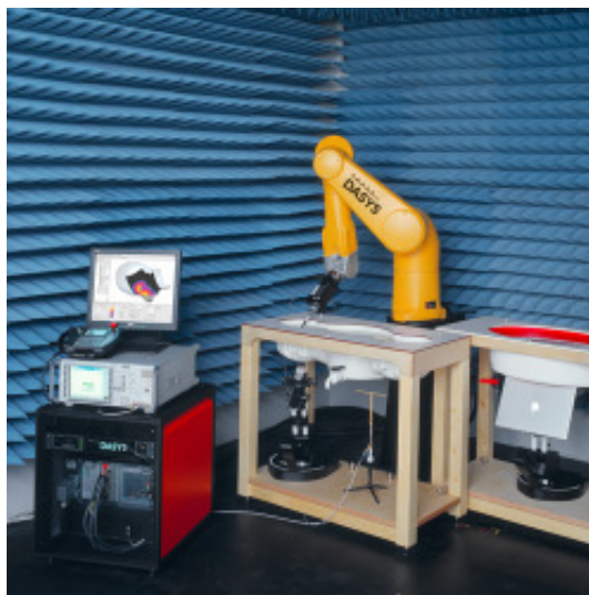
Abbildung 7: DASY5 mit einem elliptischen Phantom für SAR-Messungen nach [IEC, 2007] sowie einem Twin-SAM-Phantom
