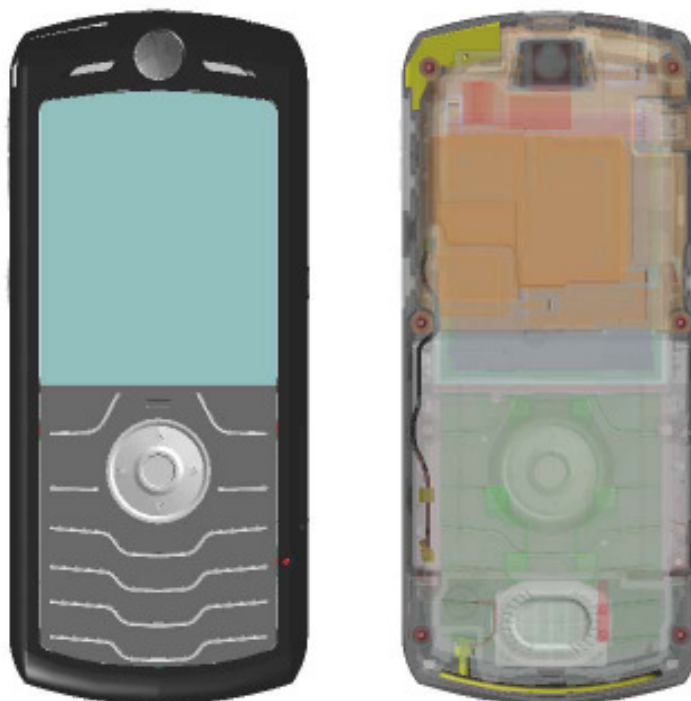
Abbildung 41: Numerisches Modell des Motorola SLVR L7 (Die rechte Abbildung zeigt den inneren Aufbau des Telefons, wobei die Antenne und die zu ihr gehörenden Hochfrequenz führenden Teile gelb hervorgehoben sind.)
