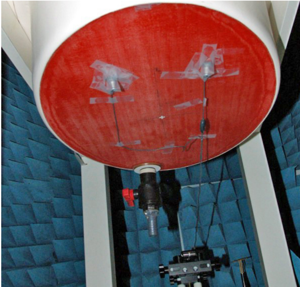
Abbildung 13: Messaufbau mit 12^\circ Winkel zwischen Headsetkabel zum Flachphantom des DA-SY5 Messsystems. (Ansicht der Unterseite des elliptischen Flachphantoms mit nach hinten weglaufendem Headsetkabel.)
