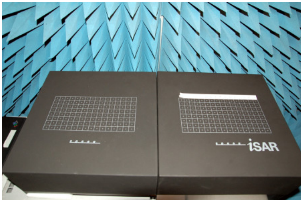
Abbildung 8: Schnelles planares SAR-Meßsystem iSAR (rechts) mit erweiterter Absorptionsfläche (linker Teil des Phantoms).
