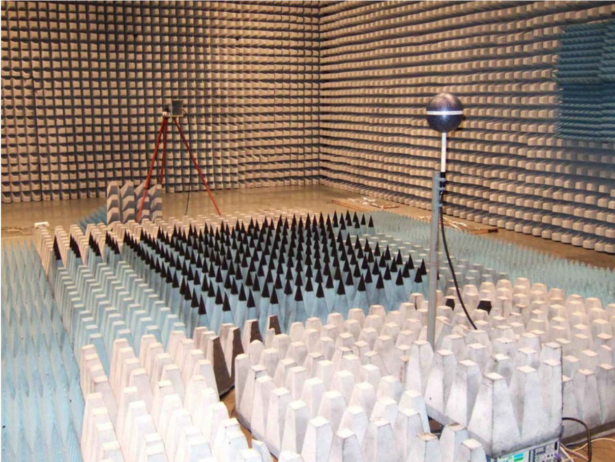
Bild 2.16: Messaufbau zur Überprüfung der Isotropie der Sonde, hier Position 1
