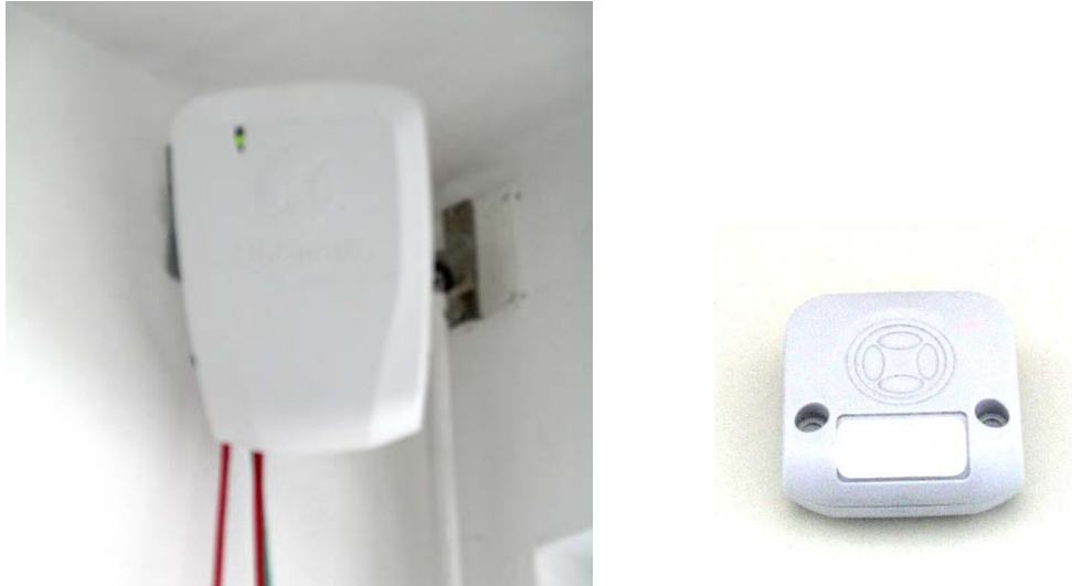
Abbildung 2.4: In einer Raumecke montierter Sensor (links) und ein Tag (rechts) des Ubisense Systems 7000
