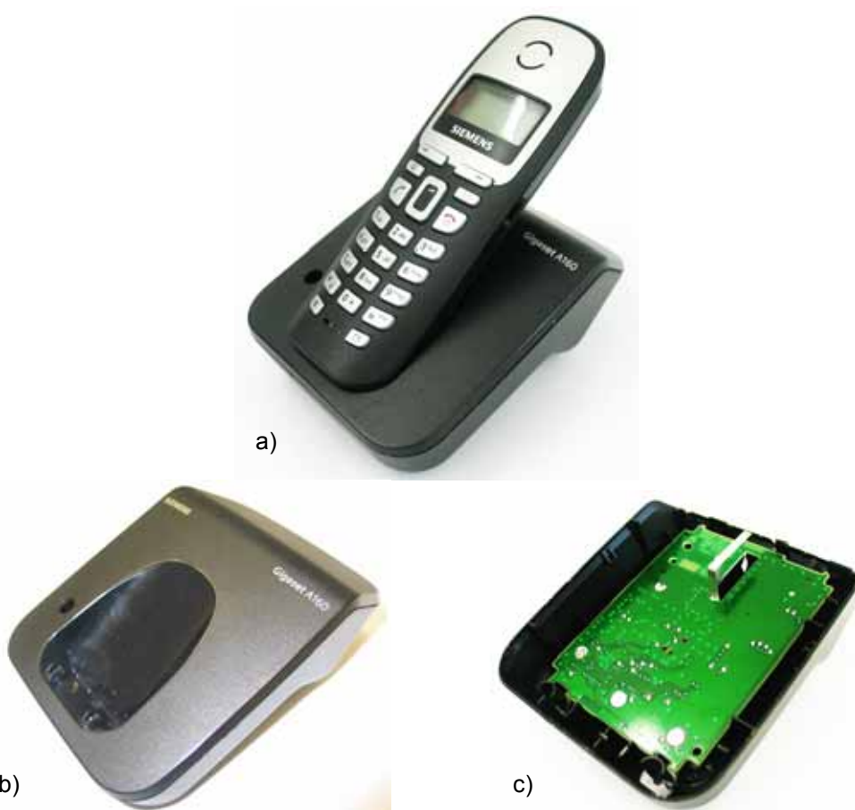
Bild 6: DECT-Schnurlostelefon Typ Siemens Gigaset A160 (typ. Nutzerentfernung: 40 cm) a) Gesamtansicht b) Außenansicht der Basisstation c) Oberseite der Basisstations-Platine mit 'inverted-F'-Antenne
