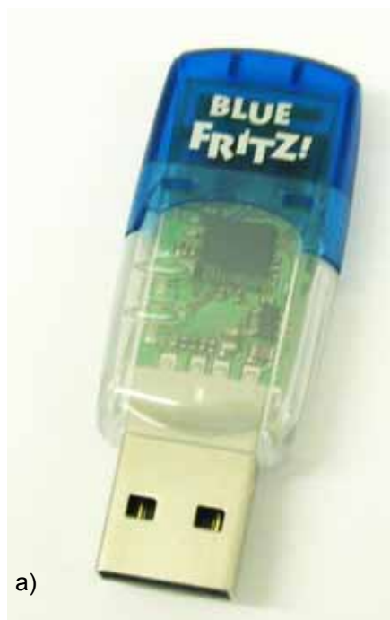
Bild 4: Bluetooth-USB-Adapter Typ BlueFritz! USB v2.0 a) Außenansicht b) Oberseite der Platine mit 2.450 MHz-Antenne
