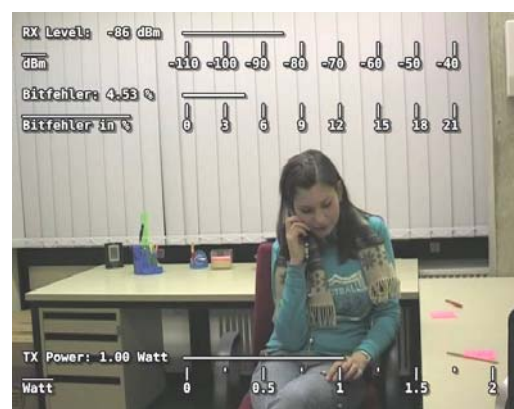
Abbildung 37: Änderung der Sendeleistung (TX Power) bei sprunghafter Änderung der Bitfehlerrate
