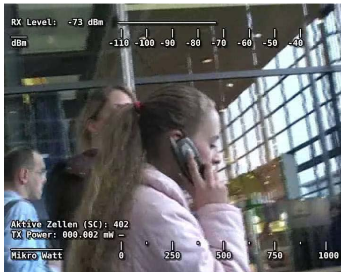
Abbildung 57: Versuchsperson 2, weiblich, 20 Jahre, beim Gang durch die CeBIT Messehalle 13 mit UMTS Nokia 6650; die Übertragung der Messdaten erfolgte mittels Bluetooth zu dem Laptop mit der Auswertungssoftware
