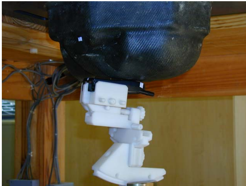
Abbildung 72: Messaufbau für die Messung des Nahfeldes mit dem Kopfphantom
