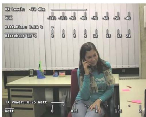
Abbildung 37: Änderung der Sendeleistung (TX Power) bei sprunghafter Änderung der Bitfehlerrate
