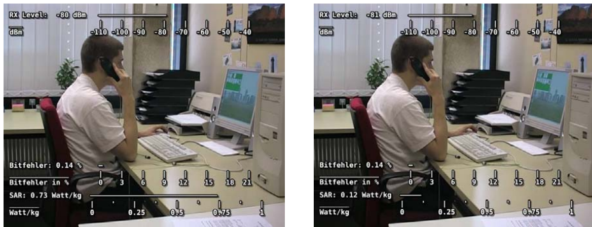
Abbildung 45: Versuchsperson (Student 2) zu verschiedenen Zeitpunkten der Messungen; eingeblendet der jeweilige berechnete SAR-Wert
