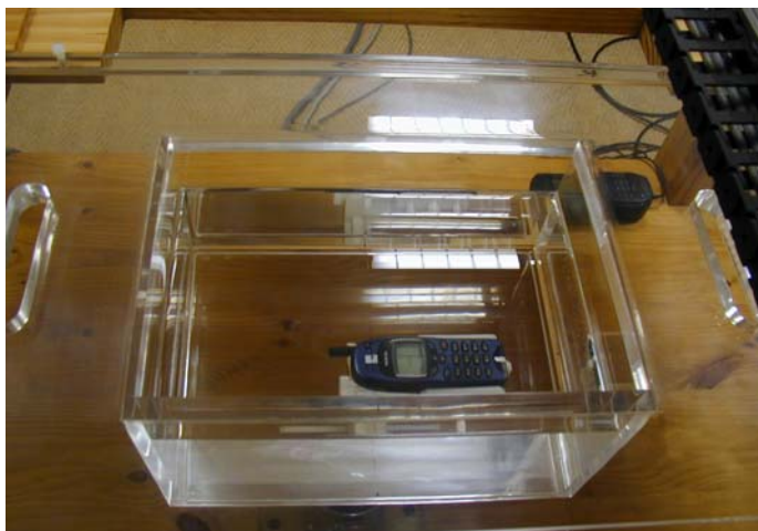
Abbildung 66: Positionierung des Mobiltelefons unter dem Plexiglasphantom – Draufsicht
