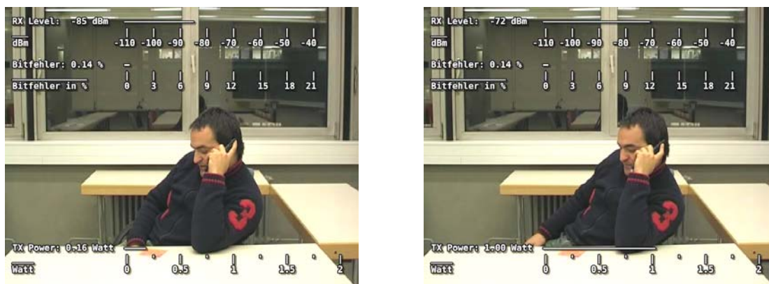
Abbildung 38: Regelung des Sendeleistungspegels (TX Power) ohne direkt erkennbaren Grund
