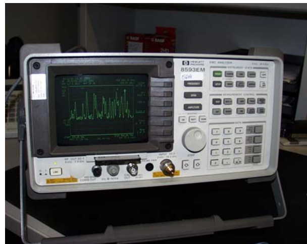
Bild I.4.2: Frequenzselektives Messverfahren mit Spektrumanalysator und Messantenne
