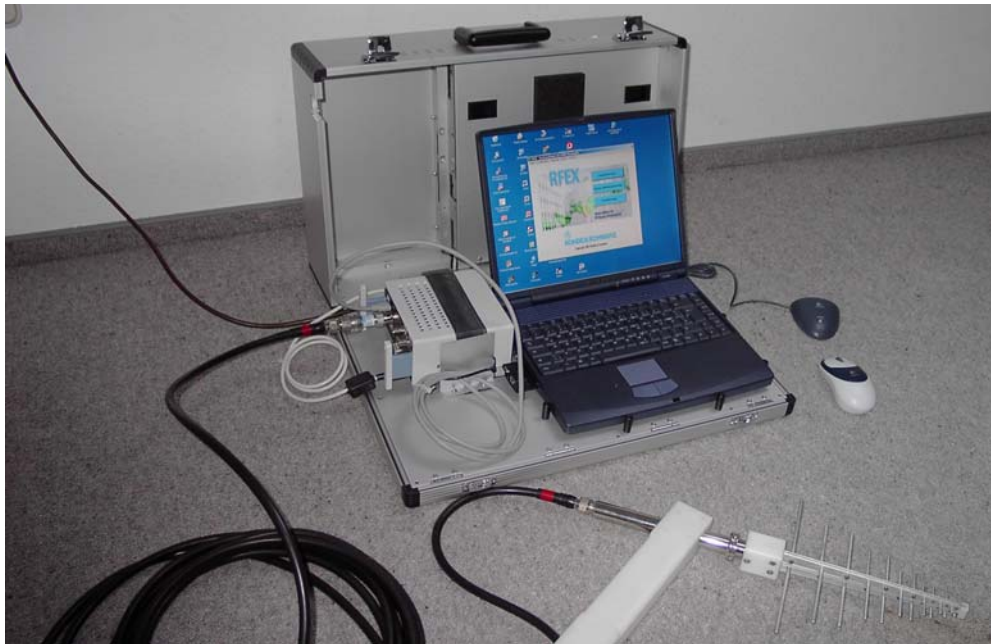
Bild I.4.3: Portables, codeselektives UMTS-Messsystem (mit TSMU, Laptop und Messantenne), Firma Rohde & Schwarz
