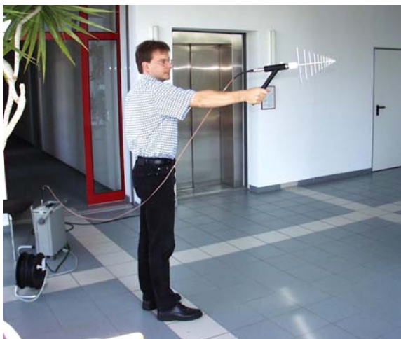
Bild I.4.2: Frequenzselektives Messverfahren mit Spektrumanalysator und Messantenne
