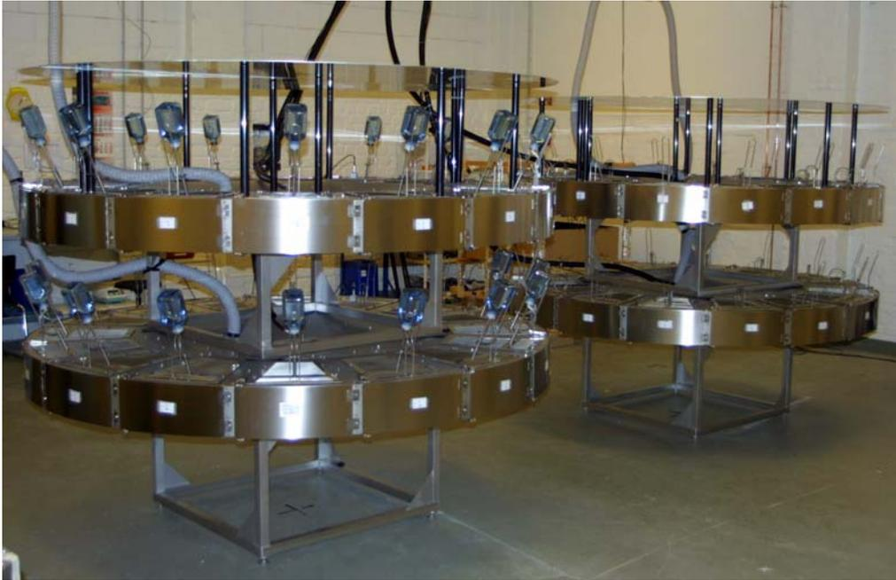
Abb. 2: Zwei der insgesamt vier doppelstöckigen Anlagen zur Exposition. Jeder Wellenleiter enthält 16 Käfigplätze.
