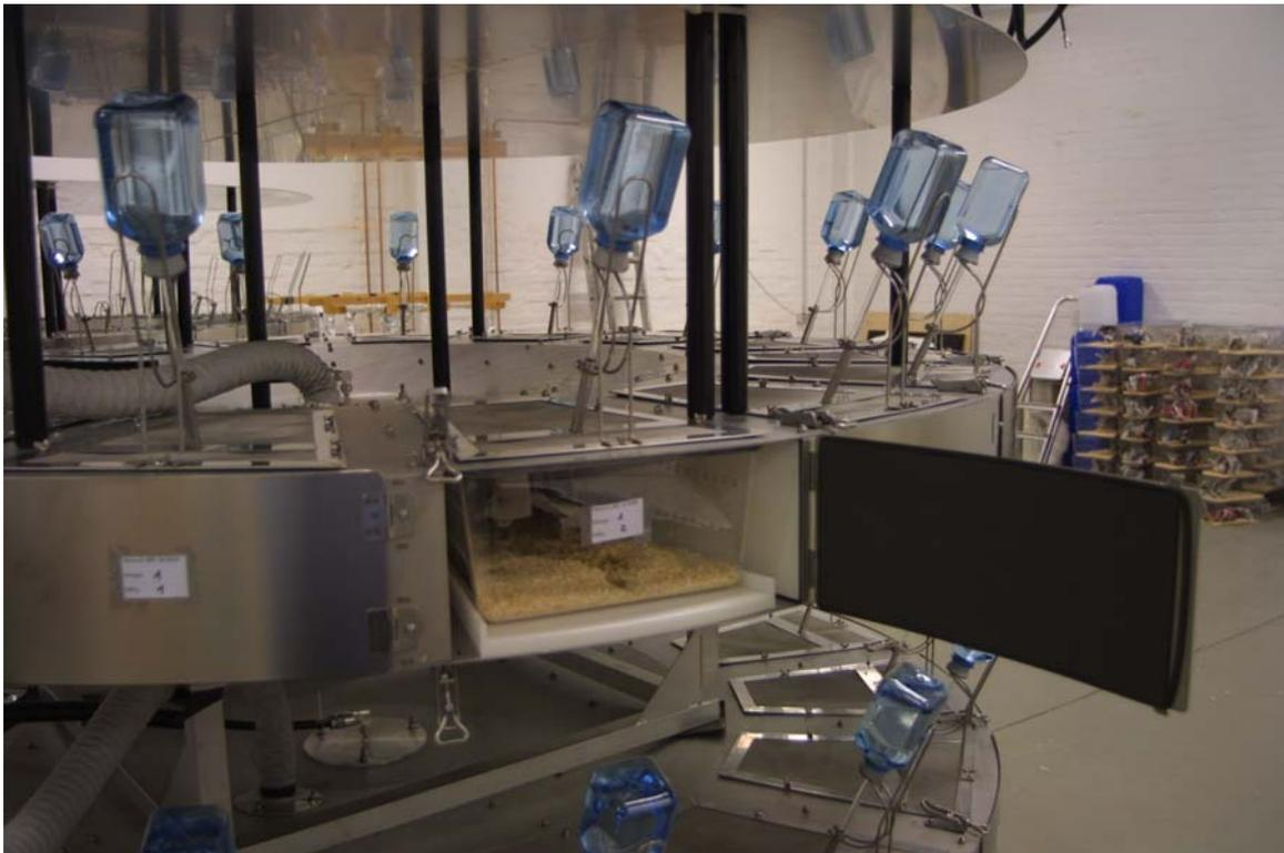
Abb. 3: Detailansicht einer Wellenleitung mit geöffneter Klappe. Die Tränkflaschen und die Glasnippel, die ansonsten durch die Plastikdeckel der Käfige ragen, werden vor Entnahme des Käfigs hochgezogen und fixiert. Die Klappen sind mit Absorbermaterial belegt und durch leitfähiges, elastisches Material zusätzlich elektromagnetisch abgedichtet. Die speziell angefertigten keilförmigen Makrolon-Käfige haben eine Grundfläche von ca. 836 cm<sup>2</sup> und eine Höhe von 155 mm.
