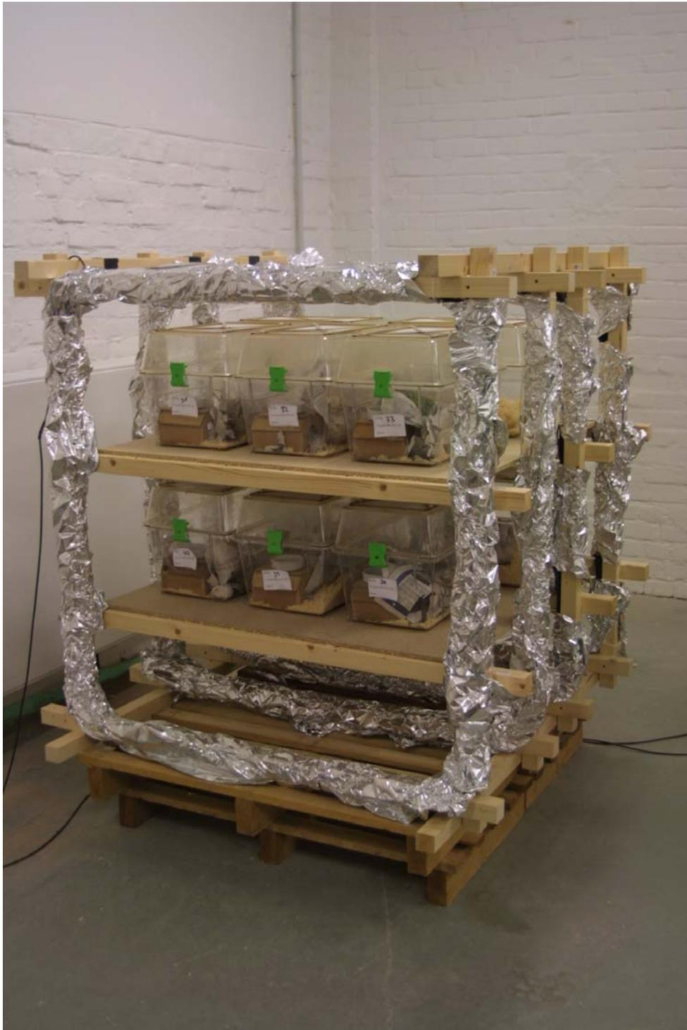
**Abb. 1:** Ein Merritt-Spulensystem für die Exposition von 80 Mäusen in 10 Käfigen auf zwei Ebenen. Die einzelnen Spulen (außen 27, innen 11 Windungen) wurden mit Aluminiumfolie umwickelt und verbunden, so dass elektrische Felder von der Spannungsversorgung der Spulen nicht auftreten konnten. Es war von außen nicht erkennbar, ob es sich um eine aktive Spule oder um eine für die Scheinexposition handelte.
