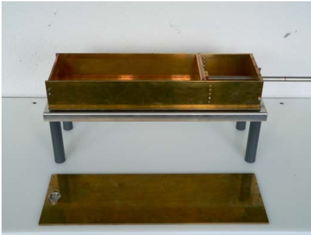
Bild 8: Resonator zur Exposition mit Signalen der Mobilfunkstandards GSM1800 und UMTS.
