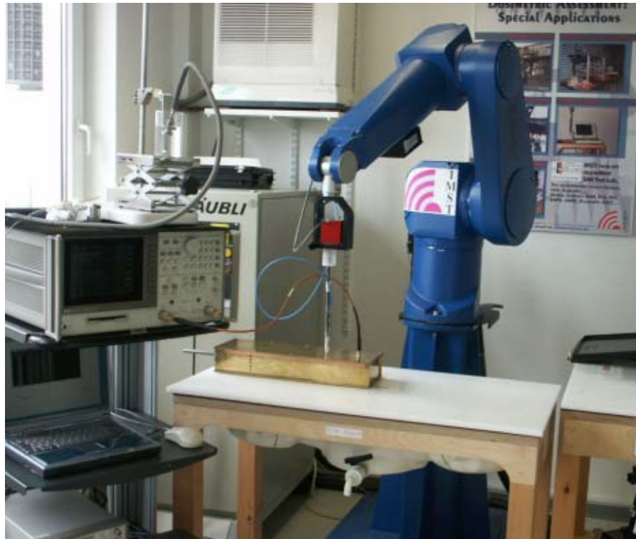
Bild 14: Vermessung des magnetischen Nahfelds im Resonator mit dem dosimetrischen Messsystem DASY4.
