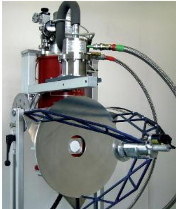
Abbildung 13: Prototyp einer passiven THz-Kamera bestehend aus einem Cassegrain Teleskopsystem mit einem 50 cm-Hauptspiegel und einem in zwei Achsen verkippbaren 12 cm-Sekundärspiegel und einem integrierten Cryogen-freien Kühlsystem [55].
